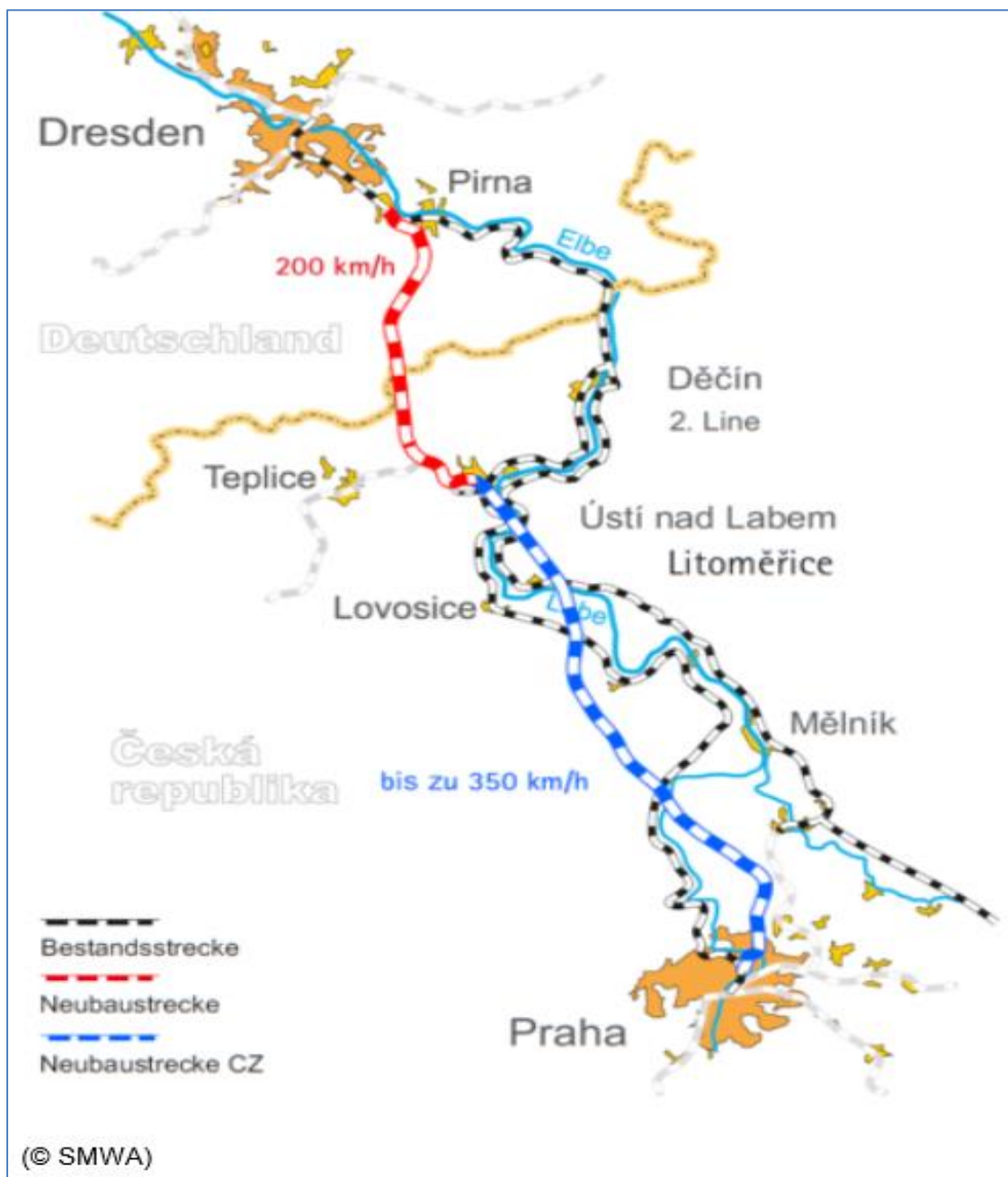
Abbildung 1: Vorhaben im Überblick; rot dargestellt der Abschnitt Dresden – Ústí nad Labem, dessen Abschnitt in Sachsen Gegenstand des Raumordnungsverfahrens ist (Darstellung: SMWA)
