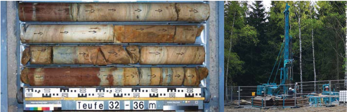
Beispiel Bohrkernkiste Neubaustrecke Erfurt–Halle (Quelle: DB AG)
